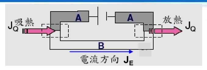
當一電流通過以上電路,一介面端會吸熱, 另一介面端會放熱;若改變電流方向,則吸 熱端與放熱端亦隨之互換 "熱" — "電"可逆
